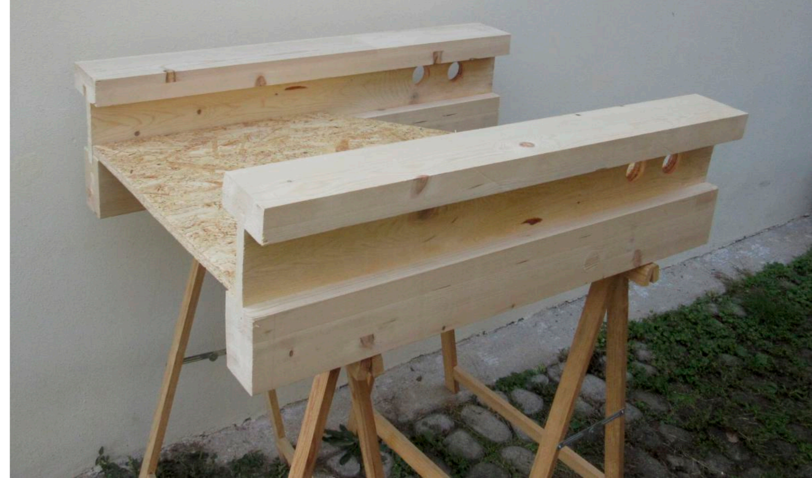
Fig. 3 Elementi strutturali in legno accoppiato con finitura a vista realizzate dagli studenti del Laboratorio di Costruzione - Scuola di Architettura del Politecnico di Milano - prof. A. Rogora e prof. R. Fedele.
