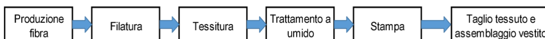
Figura 1: Articolazione delle fasi del ciclo di vita della tipologia di prodotto "Vestiti, da donna o ragazza (non a maglia)" del paniere "Abbigliamento, Scarpe e Borse" (Roos et al. 2015)
