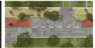
Le due fasi esecutive della pavimentazione a zona 30. La prima fase prevede un intervento soft tramite disegni sulla pavimentazione.
