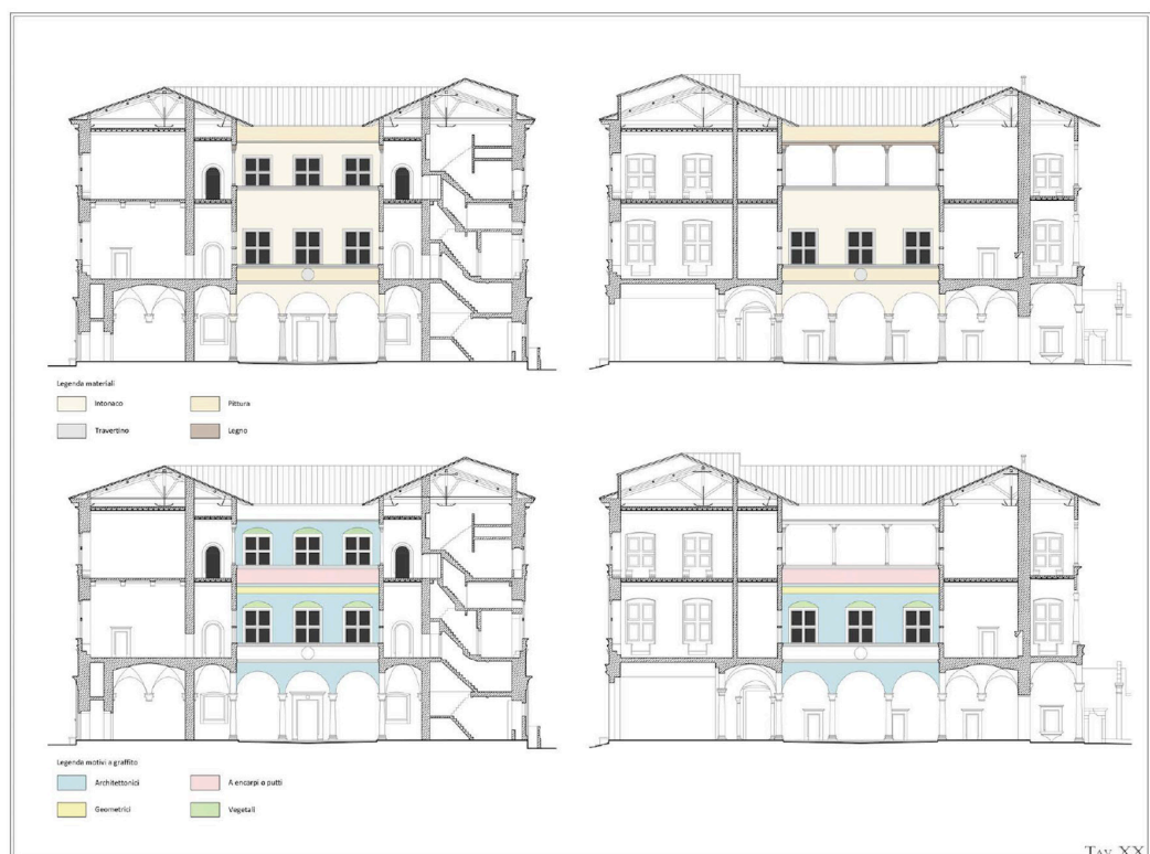
Fig. 2. Pienza, palazzo Piccolomini, Distribuzione dei motivi a graffito (elaborazione grafica degli autori).
