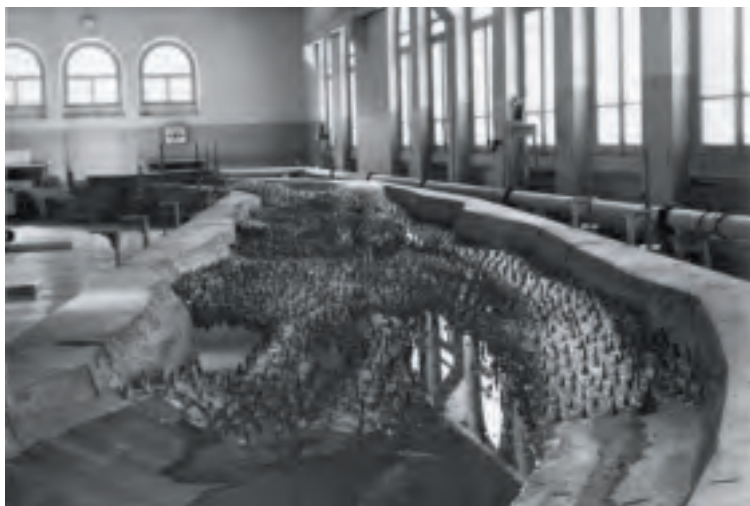
Modello del fiume Ticino, Laboratorio di Idraulica "G. Fantoli", post 1939, Archivio Storico di Ateneo, serie Miscellanea disegni, dediche, fotografie , in Archivi Storici Politecnico di Milano
