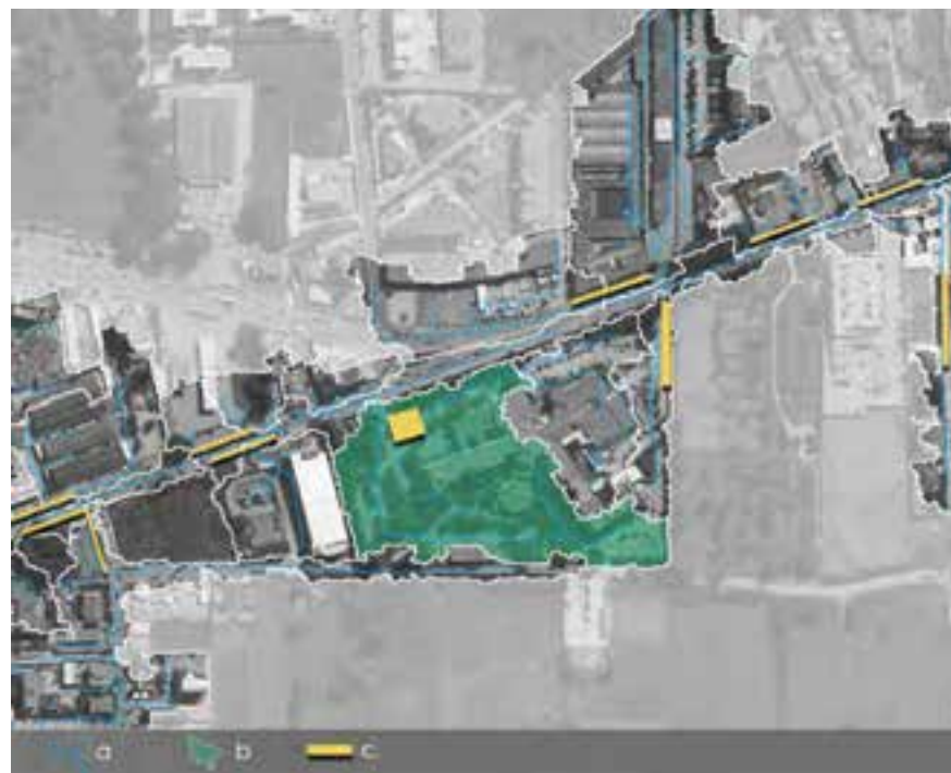
Fig. 4 - Lettura idrologica e perimetrazione di aree drenanti: linee di deflusso (a), esempio di insieme di micro-bacini (b), fabbisogni di superficie di raccolta meteorica (c) / Hydrological analysis and perimeter of draining areas: runoff lines (a), example of micro-basin ensemble (b), meteoric collecting surface requirements (c) (Source: Elaboration by Research Unit Università degli Studi della Campania Luigi Vanvitelli).
