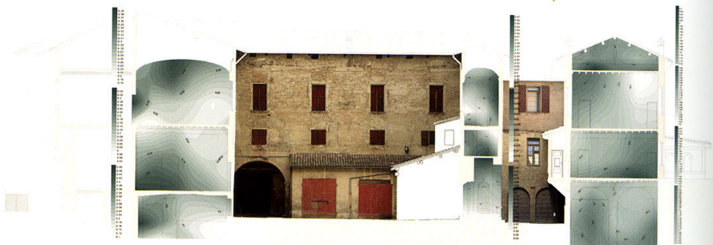
Figg. 129-131 Distribuzione di temperatura, umidità relativa e umidità specifica lungo la sezione BB. (a cura del Laboratorio di analisi e diagnostica del costruito)
