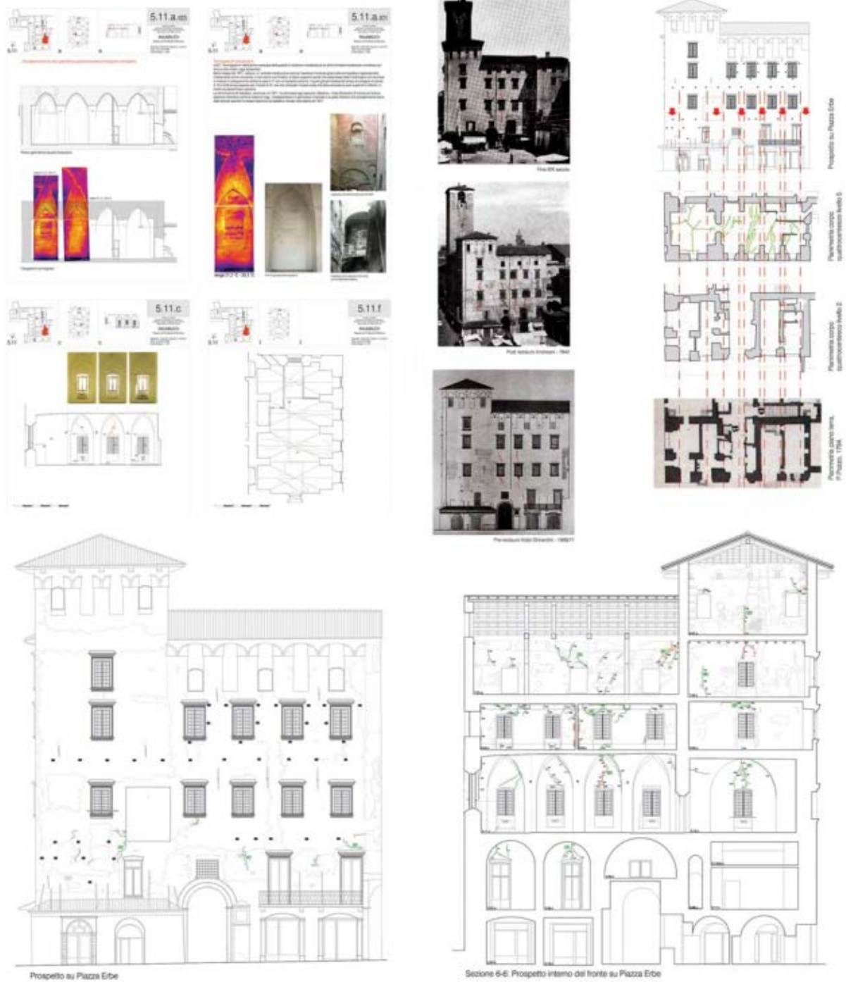
Immagine 9: Palazzo del Podestà (Mantova) – Interpretazione del dissesto nel vano 511.
