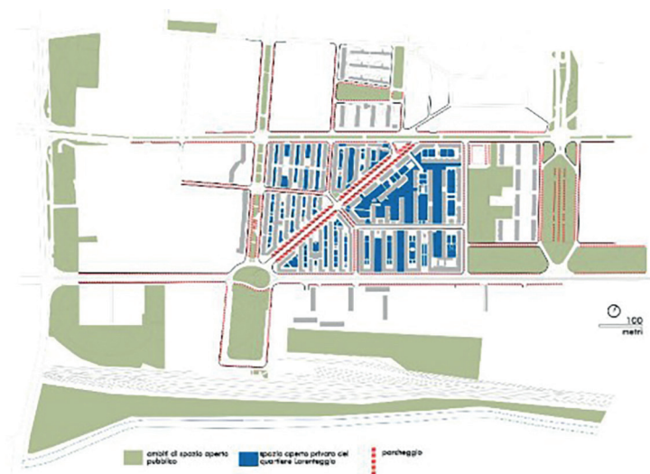
Fig. 6 – Lettura della consistenza dello spazio aperto in rapporto allo spazio edificato, allo spazio aperto di pertinenza ai quartieri e alle porzioni di carreggiate stradali destinate alla sosta degli autoveicoli. Si evidenzia la quantità di spazio occupata dai parcheggi regolamentati o tollerati [Ricerca Miur-Prin 2008].
