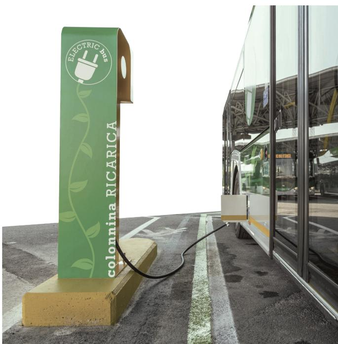
Sistema di ricarica Plug-in in deposito: la presa di corrente della colonnina viene collegata direttamente all'autobus
