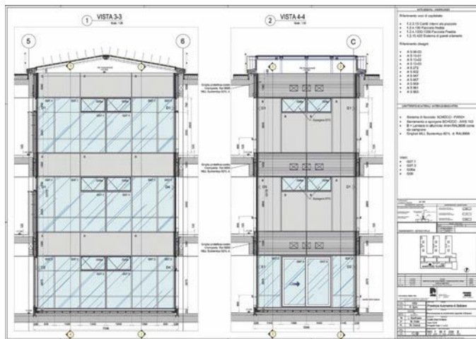
Immagine 6. Realizzazione dei pozzi luce interni all'ala nord, composti dal sistema di facciata vetrato su quattro lati e coperti dal tetto con chiusure in vetro, dotato del sistema di finestre a lamelle apribili (foto OskarDaRiz)
