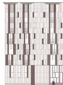
Immagine 5. Elaborazione del sistema di involucro (prospetto Est): articolazione di facciata rispetto agli impianti di risalita, ai locali di servizio, alla formulazione dei bow-window e alla successione delle finestre a tutta altezza
