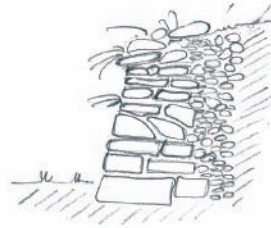
Degrado diffuso del coronamento, della base e di una parte superiore del muro
