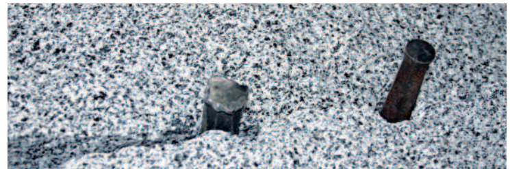
"Punchòt" per la frattura regolare di grandi pietre
