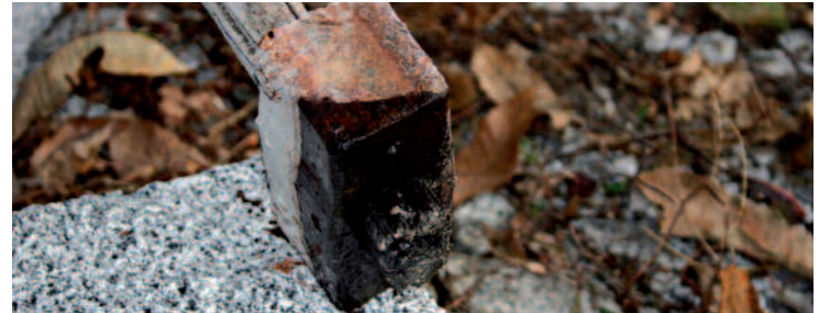
"Testù" per la sgrossatura della pietra ( a sinistra) e "mahòt" per battere lo scalpello o la punta ( a destra)
