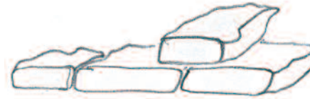
Le facce più regolari e più lisce vanno collocate verso l'esterno
