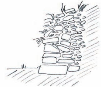
Degrado diffuso del coronamento, della base e di una parte superiore del muro
