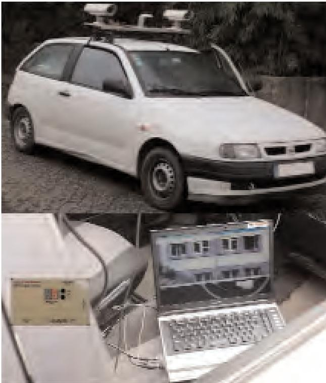
Fig.18 - I componenti del MMS a bordo del veicolo. Sul computer è visualizzabile la scansione laser in tempo reale.
