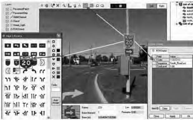
Fig.15 - Riconoscimento dei segni stradali da parte del software.
