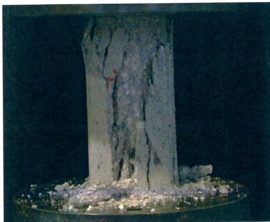
**Figura 12.** MIX 6: rottura a compressione di un provino trattato a 750°C
