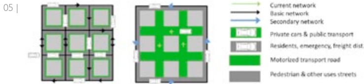
05 | Schema della rete viaria prima e dopo la realizzazione dei super blocchi. Al loro interno sono presenti esclusivamente mezzi pubblici e privati dei residenti, mentre la viabilità passante è confinata nel perimetro. Fonte: report EGCA Vitoria-Gasteiz: www.europeangreencapital.eu Diagram of the road network before and after the realization of the superblocks. They are only for public transport and private cars of residents, while the fast traffic is restricted in the perimeter. Source: report of EGCA Vitoria-Gasteiz: www.europeangreencapital.eu
