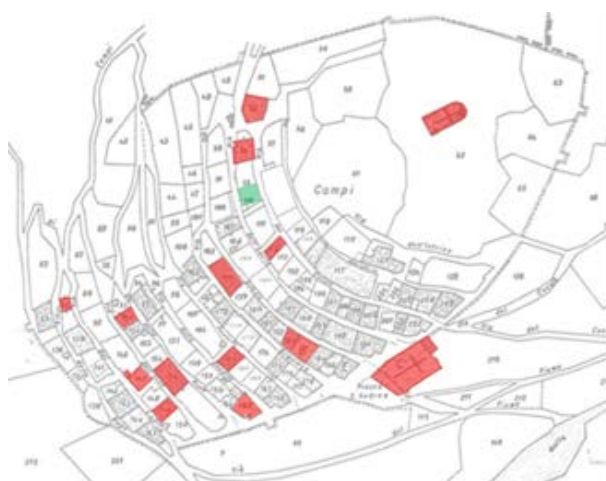
Figura 6. In rosso gli edifici interamente crollati o parzialmente crollati dal sisma dell'ottobre 2016. In verde l'unica costruzione nuova realizzata dopo il 2001.
