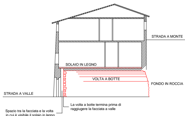
Figura 2. Schema tipologico di sezione trasversale delle case a schiera di Campi Alto (Bonfanti e Pisco 2001)
