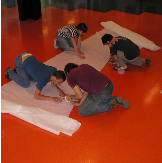
Studenti al lavoro tagliano il tessuto non tessuto per rivestire i telai
