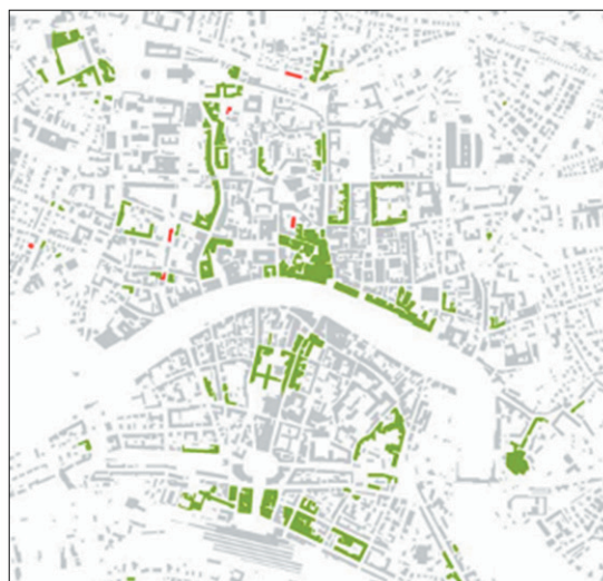
Fig. 2. Uso del GIS per la rappresentazione del fabbisogno estivo di acqua calda sanitaria per strutture di tipo ricettivo a Pisa (a sinistra) e selezione di edifici residenziali (immagine a destra, in verde) risultati idonei all'installazione di pannelli solari termici, cioè non visibili e soleggiati in copertura. Fonte: C. Casini.
