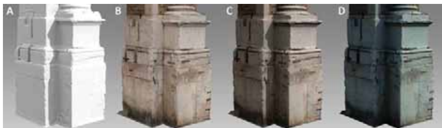
Fig. 1 – Esempi di rendering di modelli ottenuti mediante SfM. A) modello privo di texture con ombre ray tracing e global illumination . B) Colore apparente applicato come mappa di luminosità (gamma lineare). C) e D) diverse condizioni di illuminazione nelle quali è possibile osservare l'effetto di doppia ombra che tende a scurire eccessivamente le zone di maggior occlusione rispetto ai raggi di luce.
