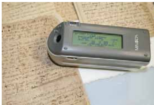
Fig. 1 - Utilizzo di un spettrofotometro portatile nel Registro Notarile di Torres.
