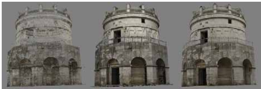
Fig. 4 – Fasi di modellazione SfM del Mausoleo di Teodorico a Ravenna.
