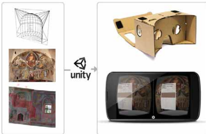
Fig. 2 - Schematizzazione del processo adottato: a sinistra modello tridimensionale, texture e dati raccolti durante lo studio dell'abside; al centro elaborazione e creazione degli script in C# all'interno di Unity 3D; a destra Cardboard e applicazione in esecuzione su smartphone Android.
