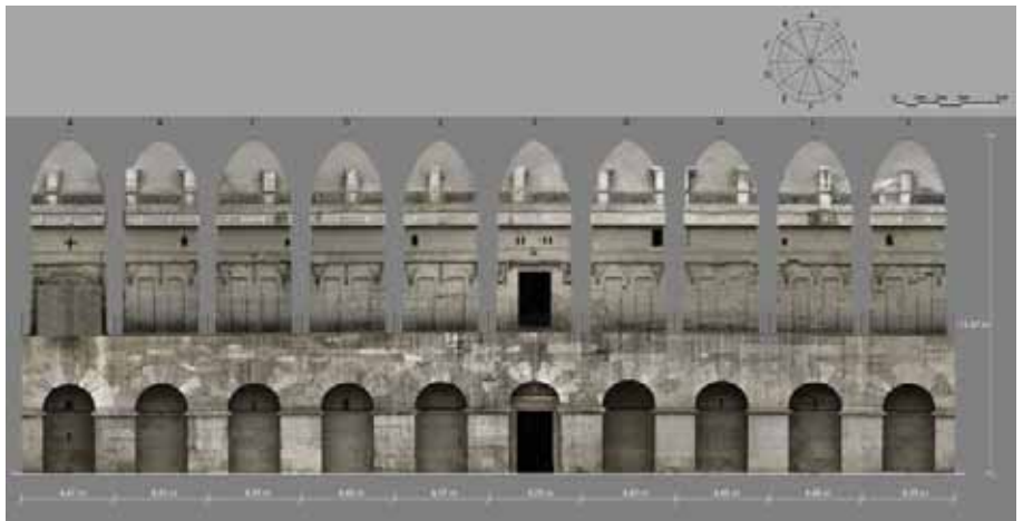
Fig. 8 – Sviluppo del Mausoleo di Teodorico eseguito a partire dal modello 3D da SfM.
