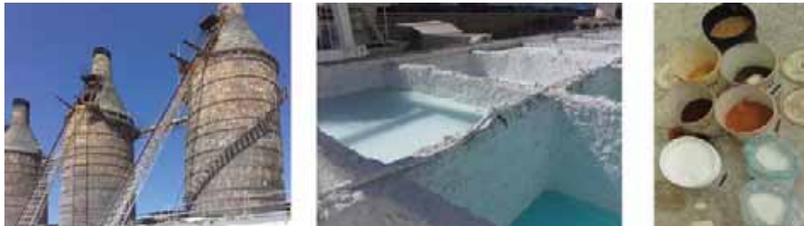
Fig. 6 - Impianto di produzione calce. Forni con combustibile a legna a tiraggio naturale; vasche di spegnimento Componenti del tonachino utilizzato nell'intervento di restauro dell'ex Convento di San Domenico a Monopoli. Adriatica Legnami Srl, Fasano (BR).
