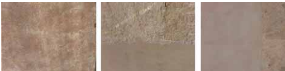
Fig. 7 - Tonachino fine a colore per le superfici di integrazione: grassello di calce ( \text{Ca OH}_2 ), additivi organici (< 2%), carbonato di calce 0.1-0.7 mm, terre colorate (5873-Giallo Verona 16.5 gr/kg, 61-Rosso Verona 16.5 gr/kg, 786 Ombra Verdastra 5.5 gr/kg), acqua q.b.
