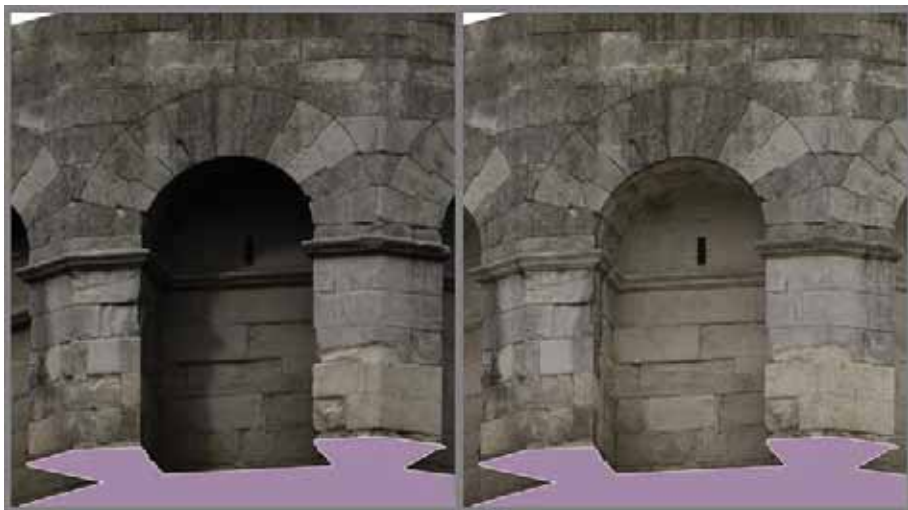
Fig. 5 – A sinistra: effetto di doppia ombra. A destra: colore apparente applicato come luminosità in gamma lineare.
