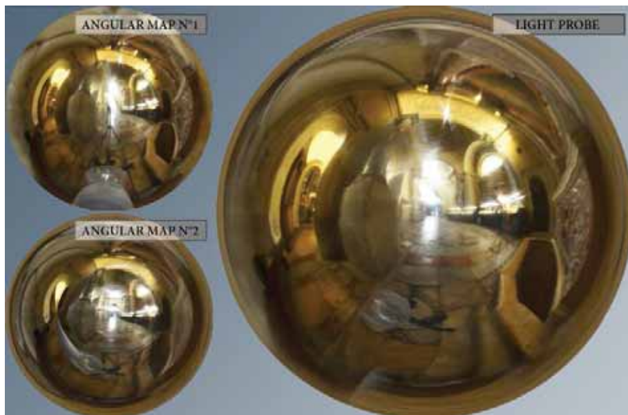
Fig. 5 – Coppia di angular maps generate tramite trasformazione sferica delle immagini riflesse da una sfera speculare e loro fusione, con eliminazione degli elementi di occlusione, per la realizzazione di una light probe personalizzata.
