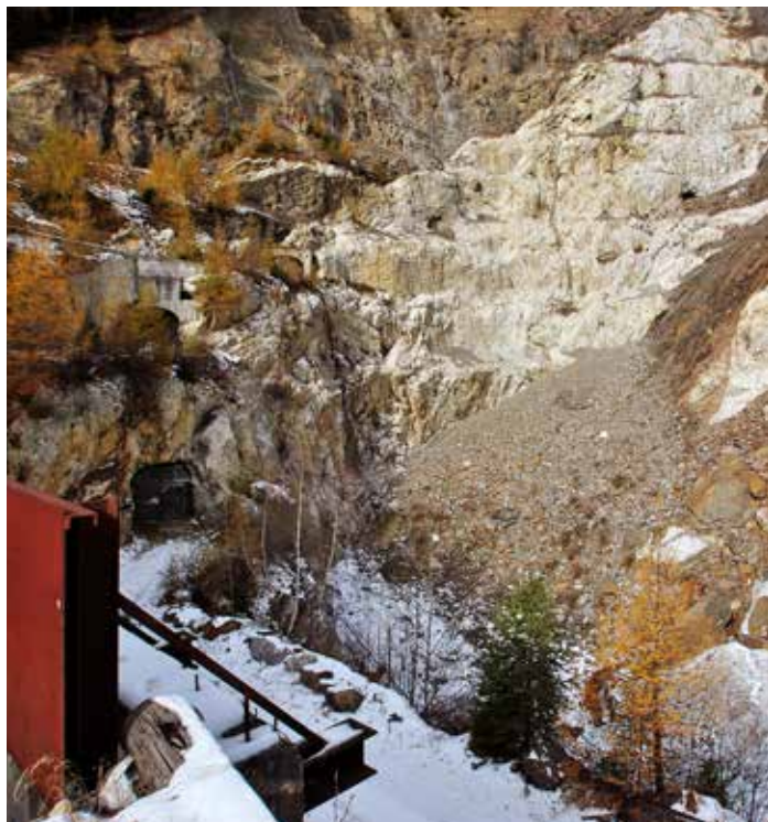
Il fronte di scavo a cielo aperto della cava di quarzo di Sondalo, situazione attuale. In basso a sinistra è visibile l'accesso al primo tunnel della miniera sotterranea.
