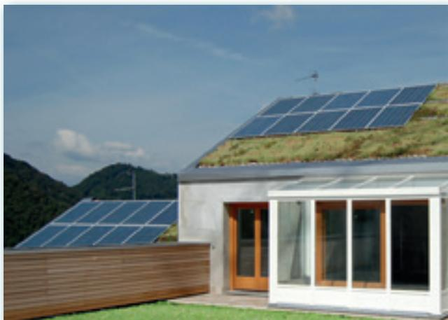
Figura 4. Villaggio ecocompatibile "CasA Selvino" a Selvino (BG), AIACE Società di ingegneria: tramite un approccio progettuale volto al guadagno solare passivo e alla conservazione del calore, gli edifici raggiungono la classe A nel rigido clima montano (foto Graziano Salvalai).
