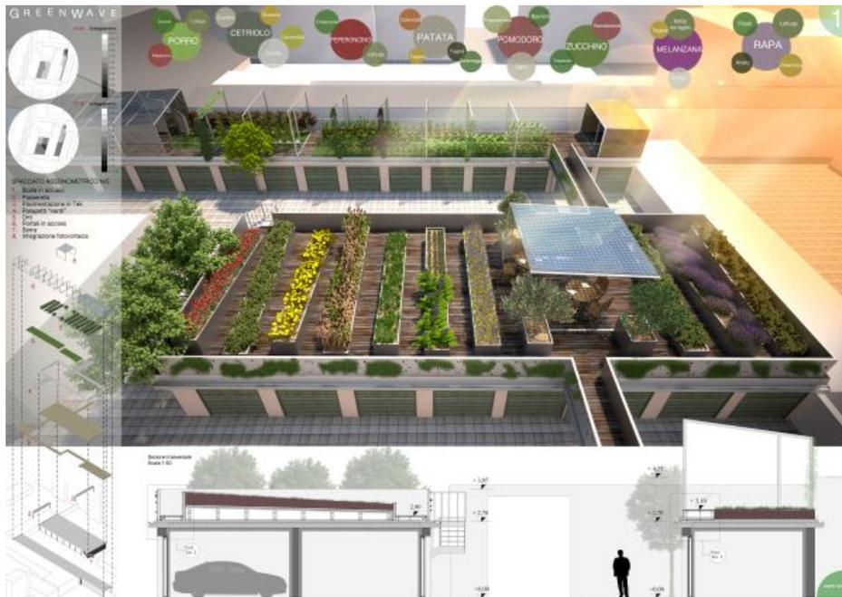
Nel terrazzo EST il progetto prevede l'installazione di vasche inclinate realizzate mediante pareti in C.A. gettato in opera e orizzontamenti in lamiera grecata inclinata grazie all'uso di muricci in laterizio.
