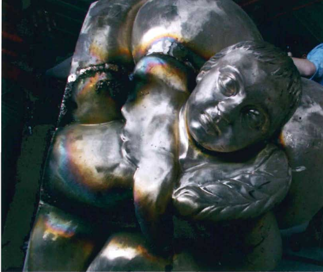
Nola, Fonderia Nolana Del Giudice, lavoro di riproduzione della Madonnina del Duomo di Milano, particolare di una delle quattro testine d'angelo che reggono il gruppo plastico della nuvola di base. Si notino le saldature tra le varie partizioni di bronzo (foto S. Carillo 2015)
