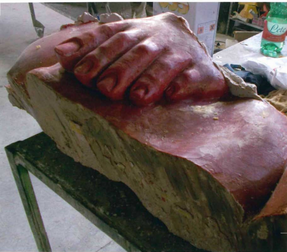
Nola, Fonderia Nolana Del Giudice, cera di una porzione del volume basamentale della statua della Madonnina del Duomo di Milano, particolare del piede sinistro (foto S. Carillo 2015)
