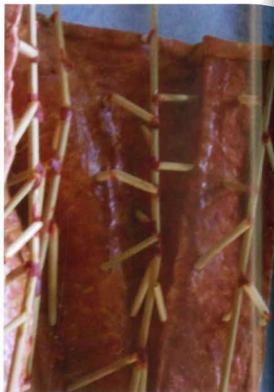
Nola, Fonderia Nolana Del Giudice, lavoro di riproduzione della Madonnina del Duomo di Milano, lavorazione di finitura dell'epidermide scultorea e allestimento delle cere con i canali di fusione (foto S. Carillo 2015)
