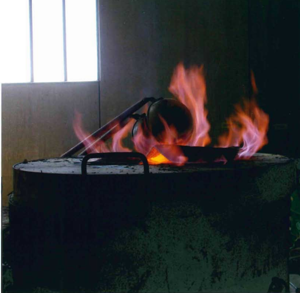
Nola, Fonderia Nolana Del Giudice, crogiolo con il bronzo fuso per le operazioni di distribuzione del metallo all'interno dei blocchi in impasto refrattario (foto S. Carillo 2015)
