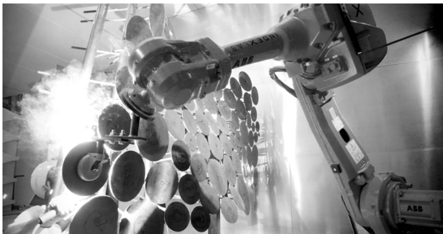
F03 | INDEXLAB "Circle Packing" 2013, Politecnico di Milano – Nieder. Prototipo di facciata progettato con processi di "form-finding" e realizzato con braccio robotico a sei gradi di libertà tramite "pick-and-place" e saldatura adattabile. La prima realizzazione al mondo di assemblaggio robotico di pannelli piani differenziati a fissaggio adattabile.
