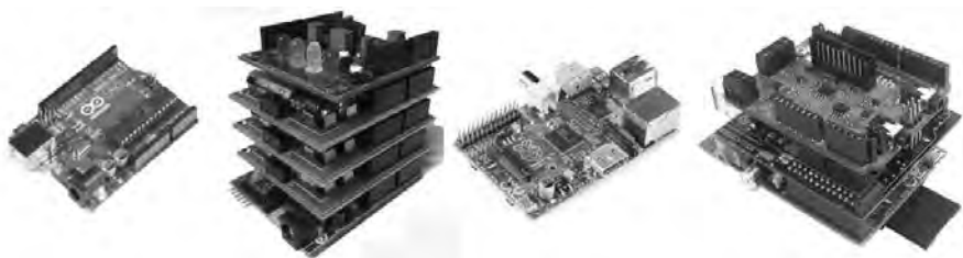
F04 | Arduino UNO – esempio di Shields di Arduino – Raspberry Pi – esempio di Shields di Raspberry Pi.
