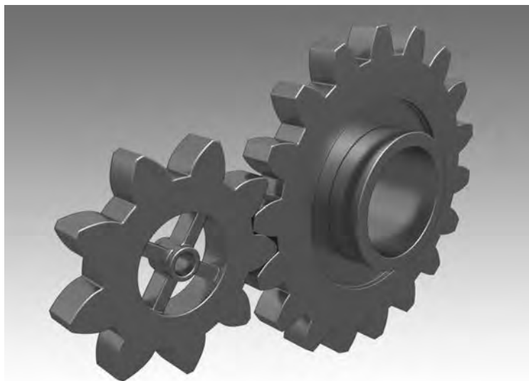
F02 | Ruote dentate cilindriche con diversa velocità angolare.
