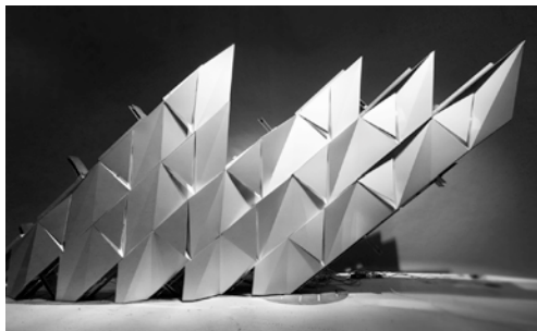
F06-07 | INDEXLAB "Shivers" 2012, Politecnico di Milano – Nieder – EverElettronica. Prototipo di facciata unico nel suo genere, progettato con processi algoritmici e logiche parametriche, realizzato con tecnologie di taglio - piega a controllo numerico e dotato di sensori e attuatori per adattarsi all'ambiente.
