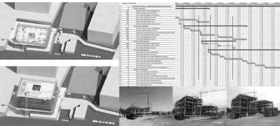
F01 | La gestione 4D del cantiere. Elaborazioni grafiche correlate a diagrammi di Gantt. V. Mottola, M. De Luca Picione.
