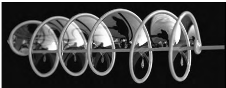
F01 | Elicoide ottenuto attraverso l'immersione di un telaio di filo di ferro nell'acqua saponata.
