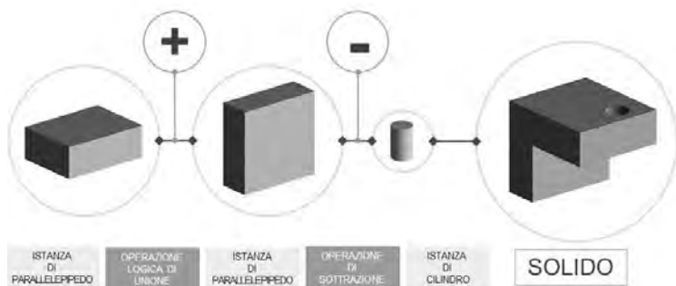
F02 | Schema di funzionamento dei modellatori solidi CSG.
