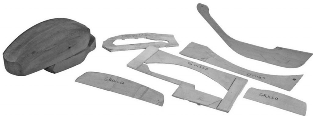
F01 | Modello in legno con dime del telefono Grillo di Marco Zanuso e Richard Sapper per Siemens, 1965 Foto: Federico Pollini – Archivio Giovanni Sacchi.
