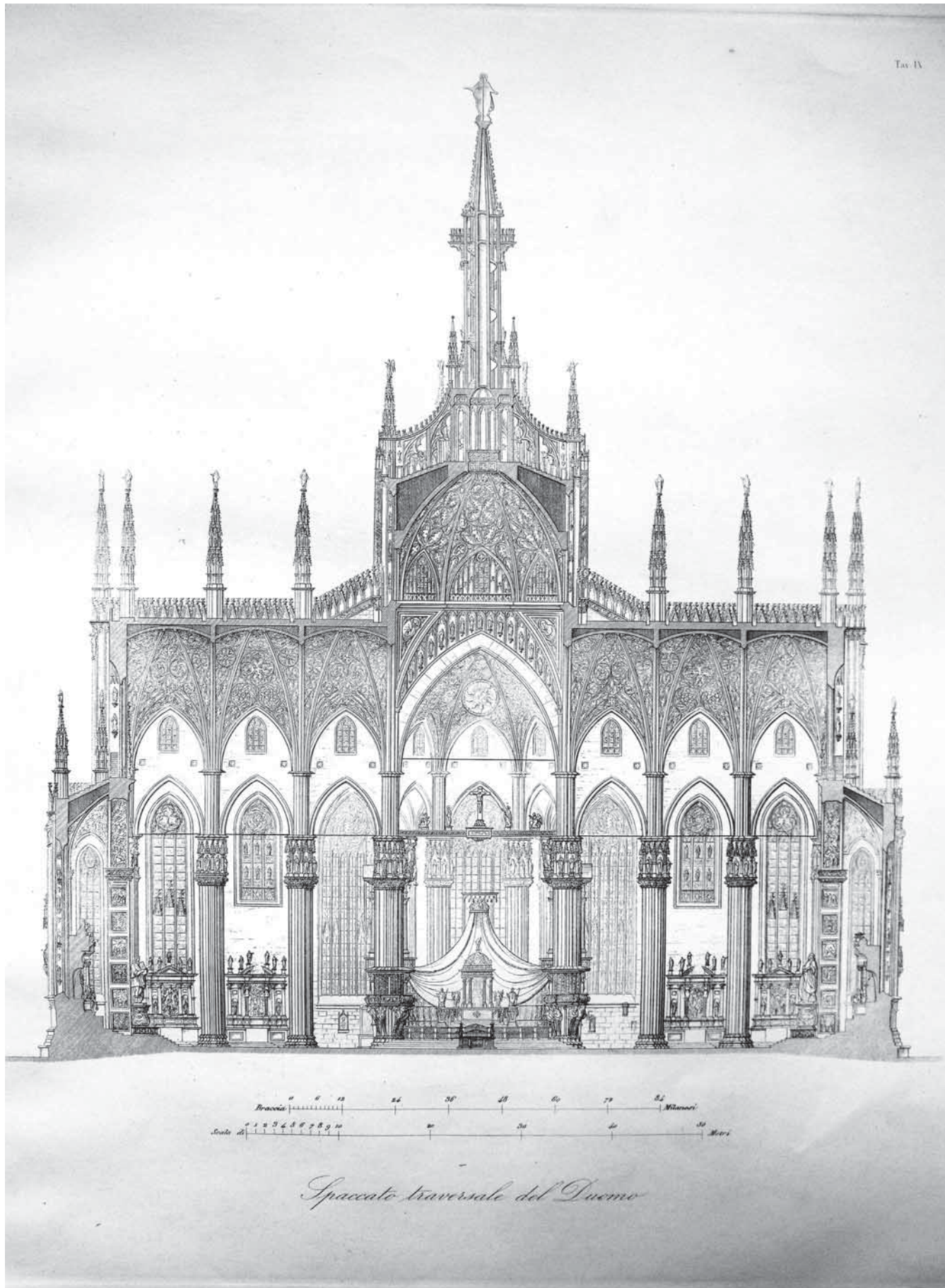
Fig. 7. Fratelli Bramati, Spaccato trasversale del Duomo di Milano (da F. ZUCCARI, G. DE CASTRO, Il Duomo di Milano , Milano 1863).
