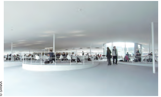
Fig. 262 SANAA, Rolex Learning Center, Losanna, Svizzera, 2004-2010 Il pavimento in moquette è particolarmente adatto, per le sue caratteristiche fonoassorbenti, agli ambienti pubblici e di lavoro, soprattutto se open space. Come in questo caso, dove le curve e le pendenze che definiscono lo spazio interno sono rivestite da uno strato continuo di moquette grigia
