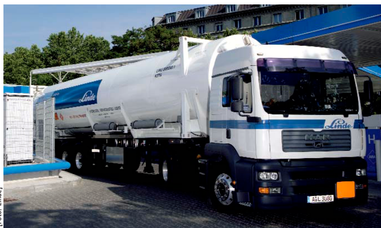
Rifornimento di un impianto di distribuzione idrogeno
