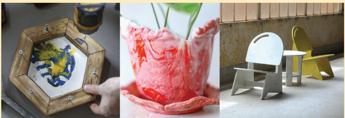
Fig. 2. Proceso y productos de Clandestino Lab, en Panamá. La imagen muestra desde la experimentación inicial con plásticos reciclados en moldes artesanales, hasta la fabricación de mobiliario producido a partir de residuos plásticos industriales. Fotografía cortesía de Clandestino Lab.
