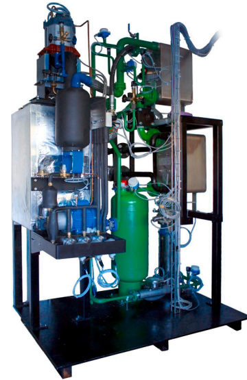
Fig. 1. ORC test rig.
