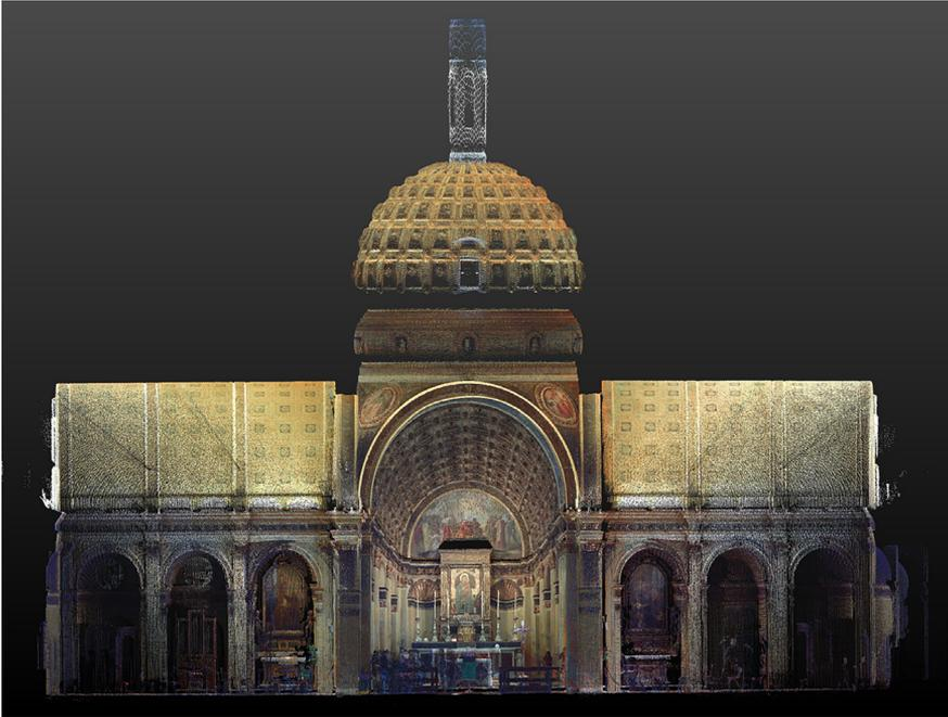
Fig. 22 Nuvola di punti risultante dall'assemblaggio delle diverse scansioni laser dell'interno della chiesa, sezione al transetto.
