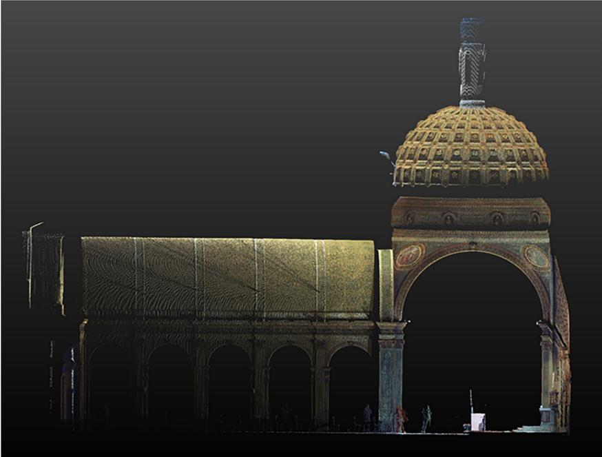
*Fig. 23* Nuvola di punti risultante dall'assemblaggio delle diverse scansioni laser dell'interno della chiesa, sezione della navata e dell'abside.
