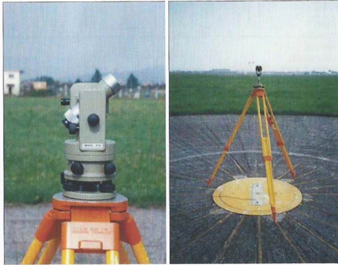
Figura, 16.10. Wild T0 – Teodolite magnetico e piazzuola di calibrazione
