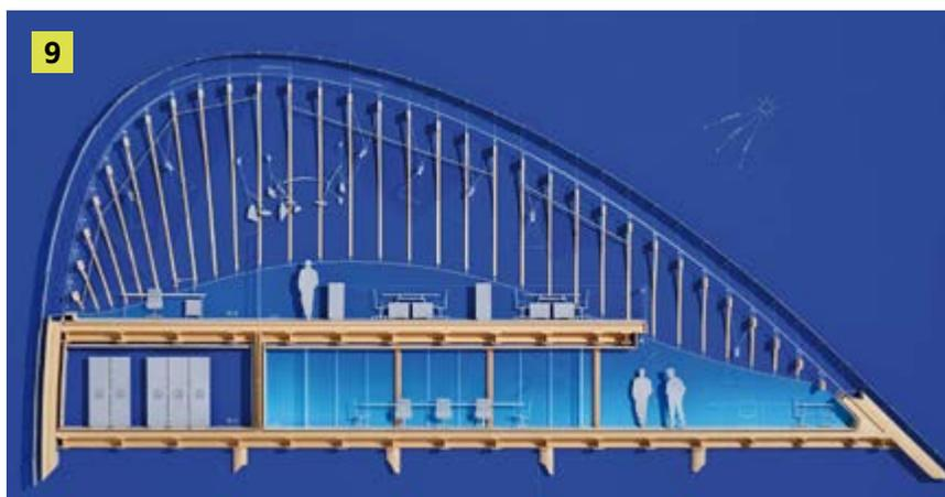
**9** Procedure di modellazione fisica: combinazione tra l'assetto tipologico interno, gli apparati strutturali principali, il guscio cementizio perimetrale e la centinatura superiore che accompagna la struttura voltata a curvatura multiforme
