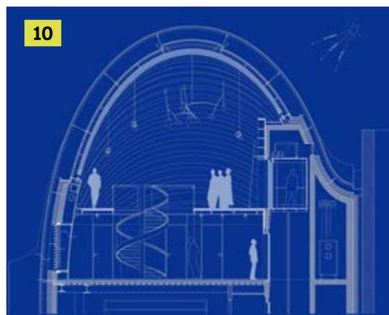
**10** Disegno di localizzazione (sezione trasversale). Combinazione della serie di trame, intelaiature e tessiture a supporto della stratificazione termoisolante, dei moduli in vetrocamera con doppia curvatura e del rivestimento in lamelle di alluminio
