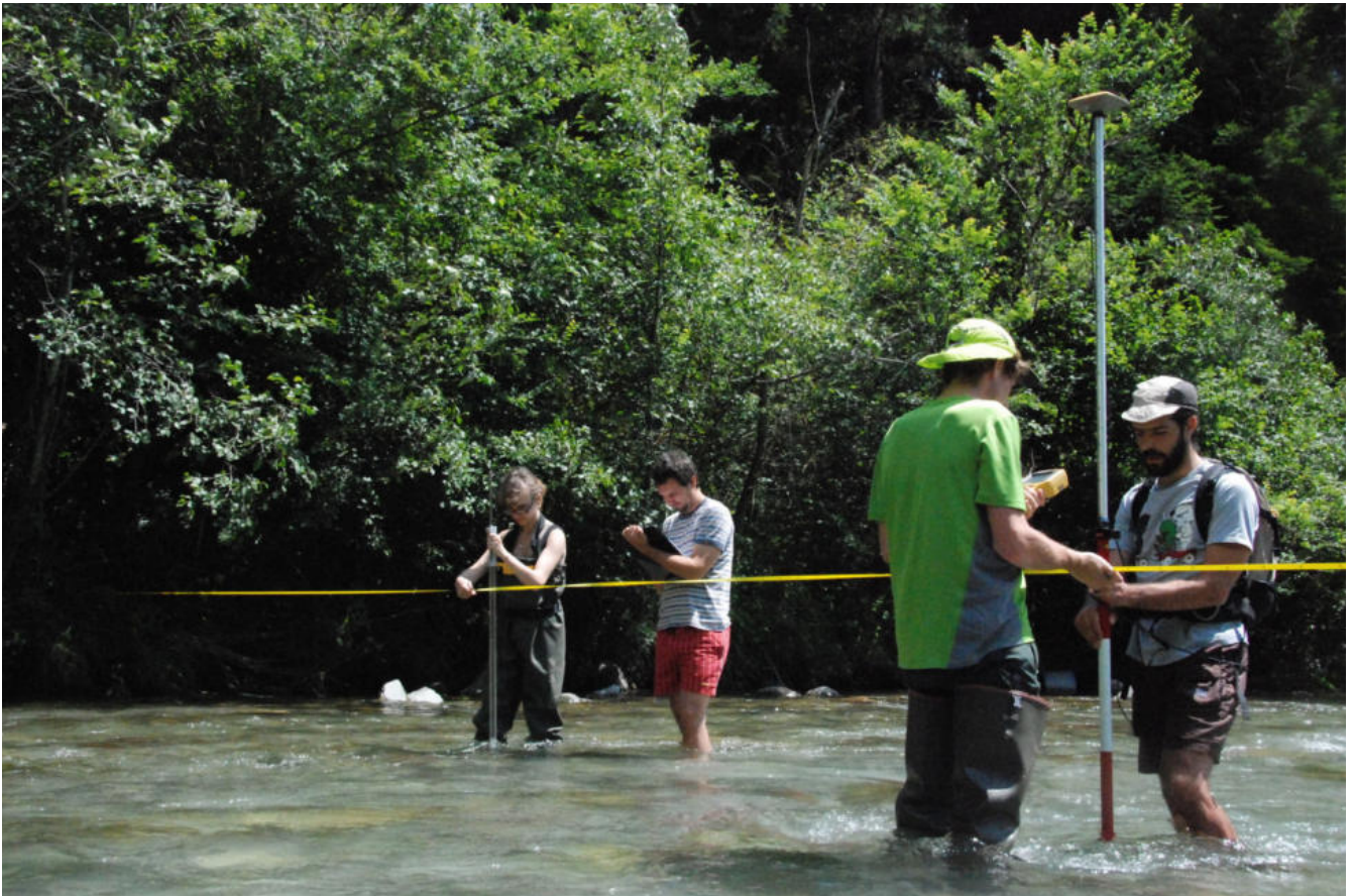
Determinazione della portata e mappatura degli habitat in una sezione fluviale. Progetto ReLambroSE – Foto di Sergio Canobbio
