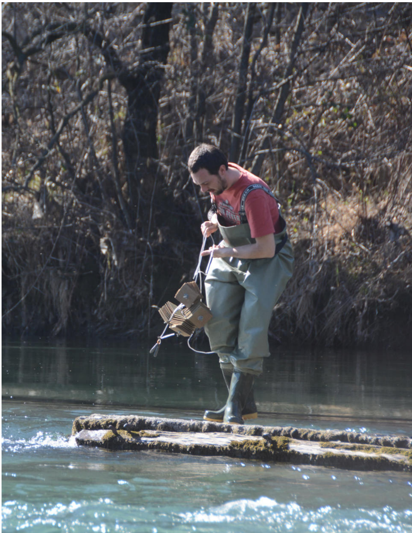
Posizionamento di substrati artificiali nell'alveo di un fiume non guadabile. Progetto ReLambroSE – Foto di Sergio Canobbio
