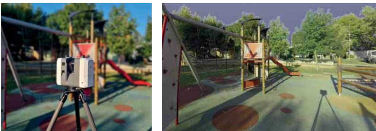
Fig. 4-5 - La strumentazione oggi più adatta a rilevare tutte le informazioni necessarie per un Parco della Salute è senza dubbio costituita dai sensori laser scanner dotati di tecnologia SLAM ( Simultaneous Localization And Mapping ).
