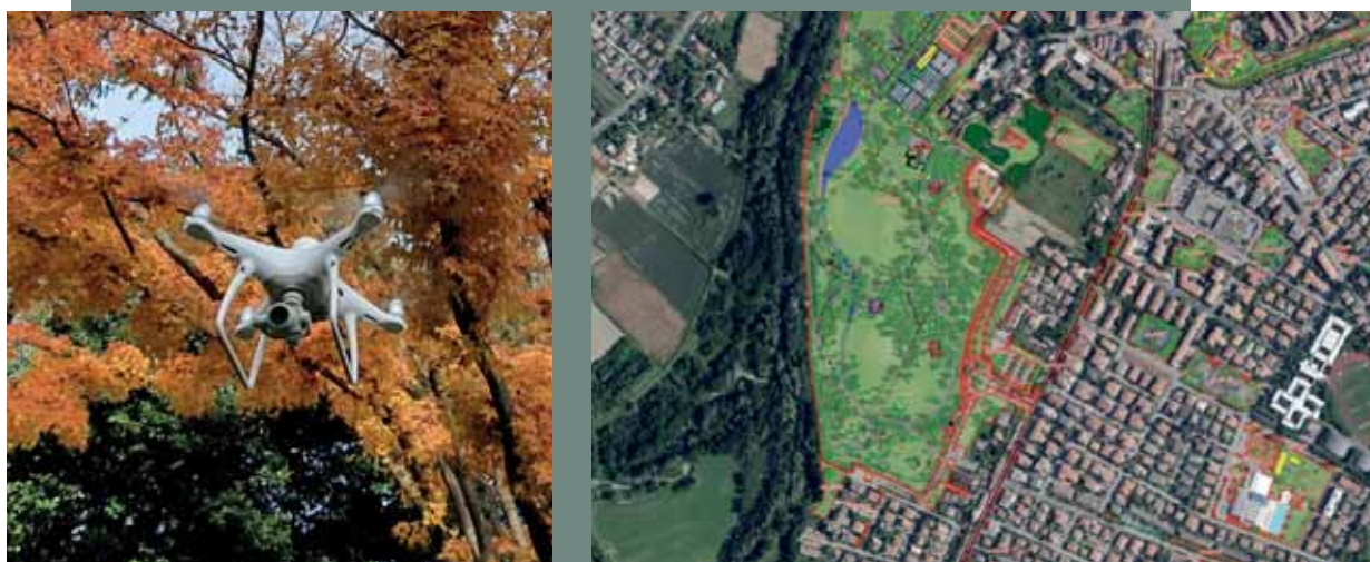
Fig. 1-2 - Per le necessità di conoscenza preliminare, un Parco della Salute deve dotarsi di un rilievo topografico di dettaglio, da realizzarsi tramite l'utilizzo di strumentazioni sempre più sofisticate a supporto di informazioni sempre più dettagliate che vanno gestite nel tempo.
