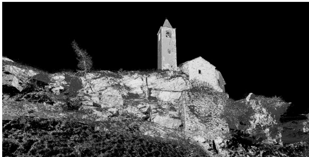
Fig. 3. La nuvola di punti ottenuta dal rilievo laser-scanner della chiesa
