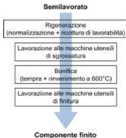
Figura 13.10 – Schema del ciclo tecnologico necessario per fabbricare un componente con un generico acciaio da bonifica.
