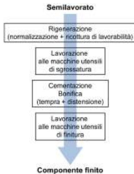
Figura 17.23 – Schema del ciclo tecnologico per un componente realizzato con un generico acciaio da cementazione.
