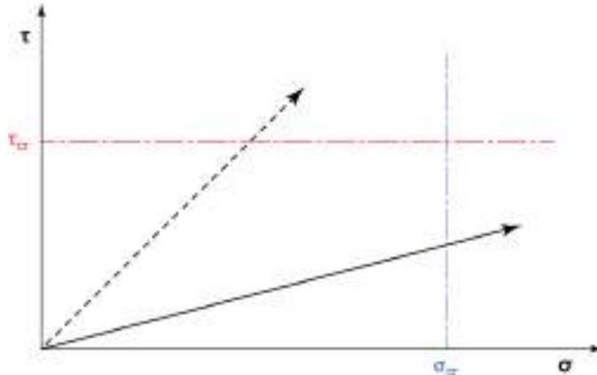
Figura 5.6 – Condizioni di carico per cui il cedimento si manifesta per scorrimento (linea nera tratteggiata) o per clivaggio (linea nera continua) [tratto da Brooks et al. 1993].
