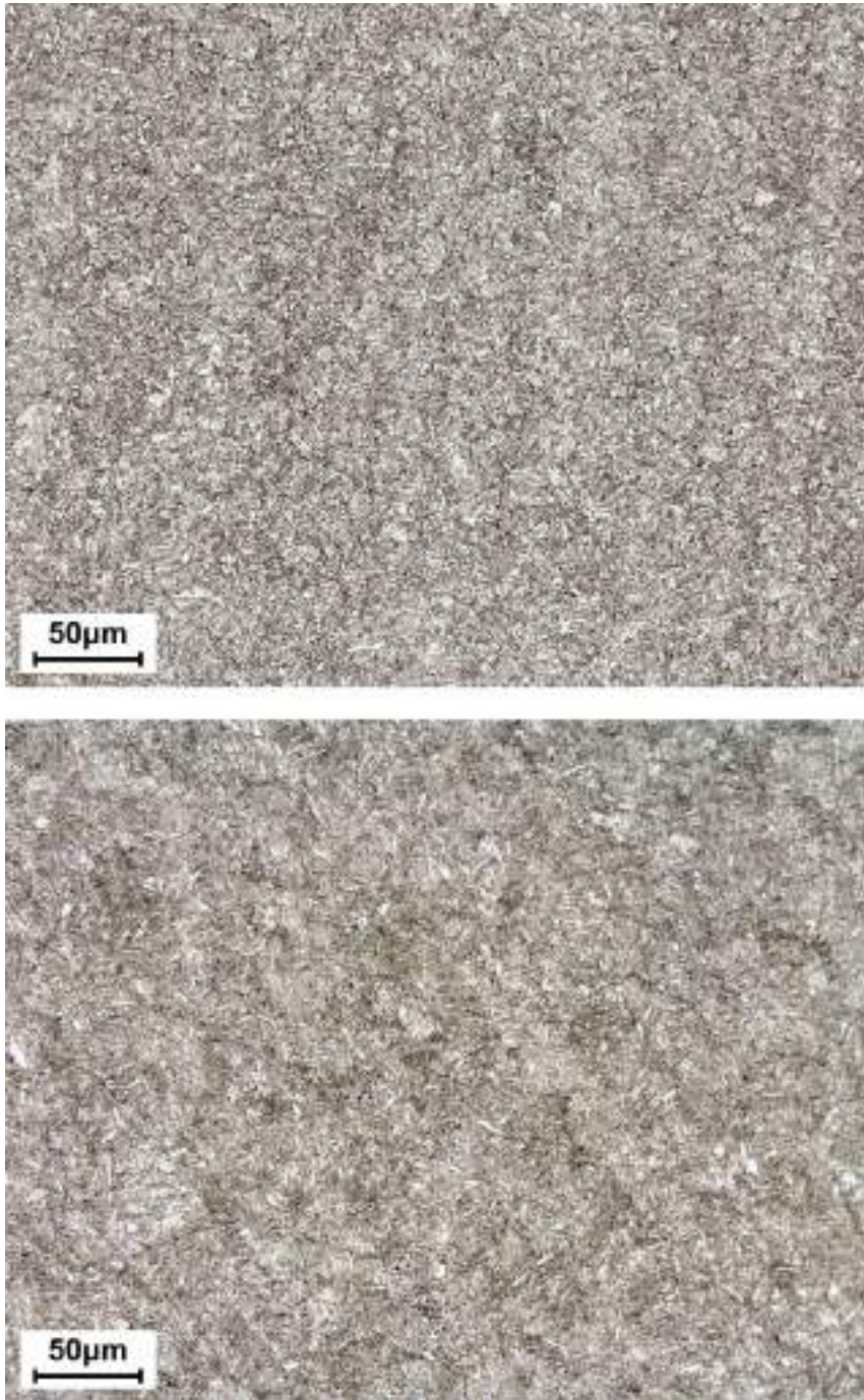
Figura 13.2 – Aspetto metallografico della struttura martensitica rinvenuta di un acciaio (in alto) tipo EN 42CrMo4 e (in basso) tipo EN 36CrNiMo4 [Laboratori Exova S.r.l., Crema – CR].
