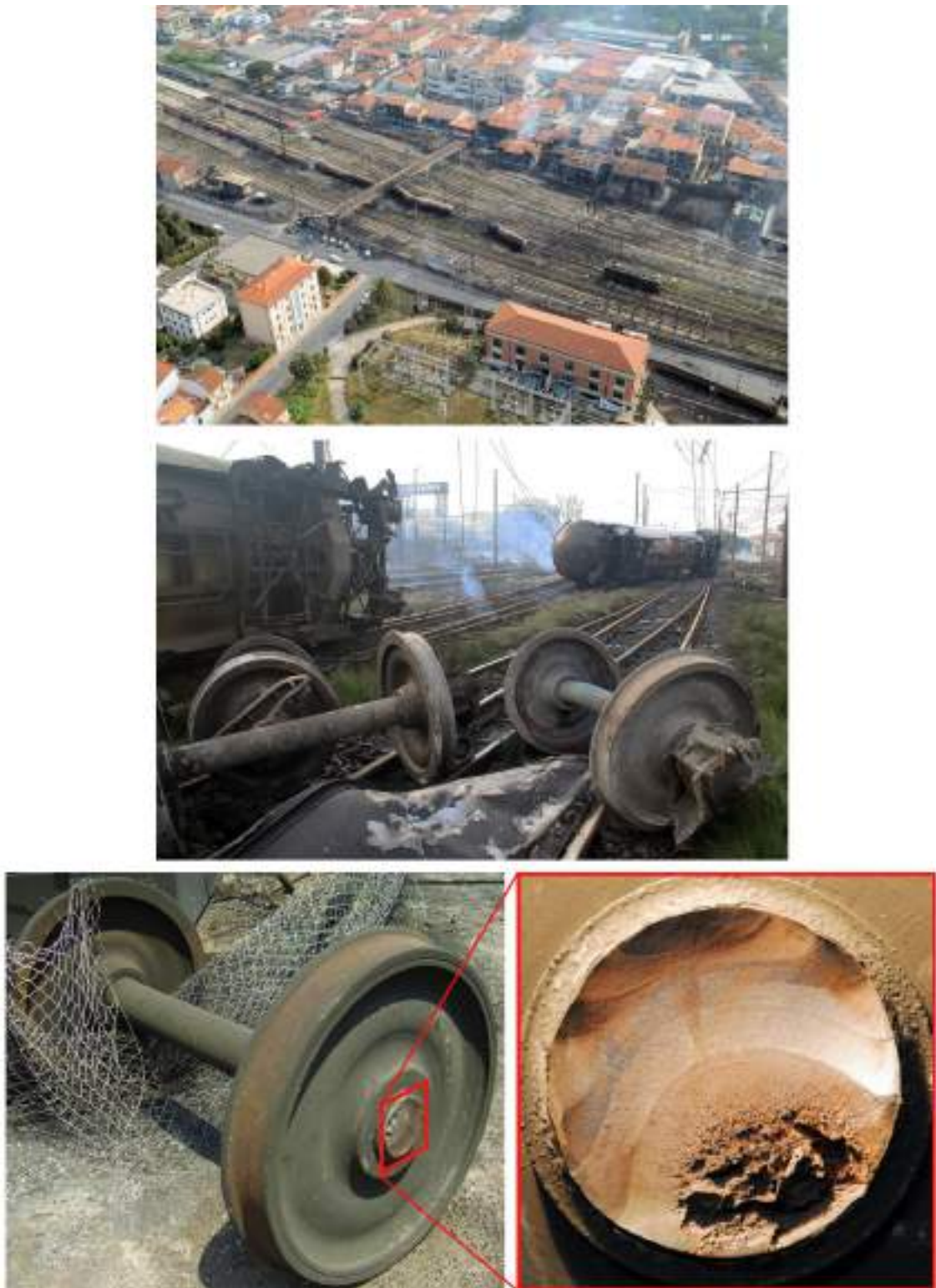
Figura 6.2 – Incidente ferroviario di Viareggio del treno merci 50325 Trecate - Gricignano. Dettaglio della superficie di frattura dell'assile rotto per fatica [fotografie POLFER, incidente ferroviario di Viareggio, 29 giugno 2009].
