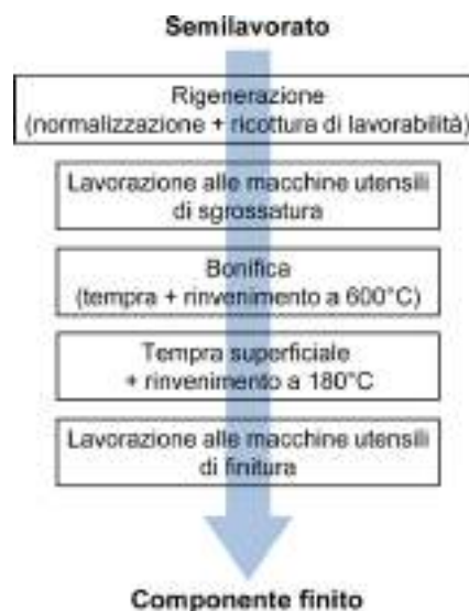
Figura 14.6 – Schema del ciclo tecnologico di un componente in acciaio da bonifica temprato superficialmente.
