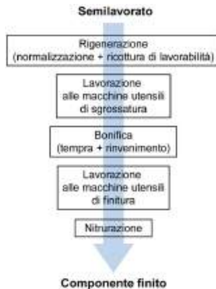
Figura 18.14 – Schema del ciclo tecnologico necessario per fabbricare un componente con un generico acciaio da nitrurazione.
