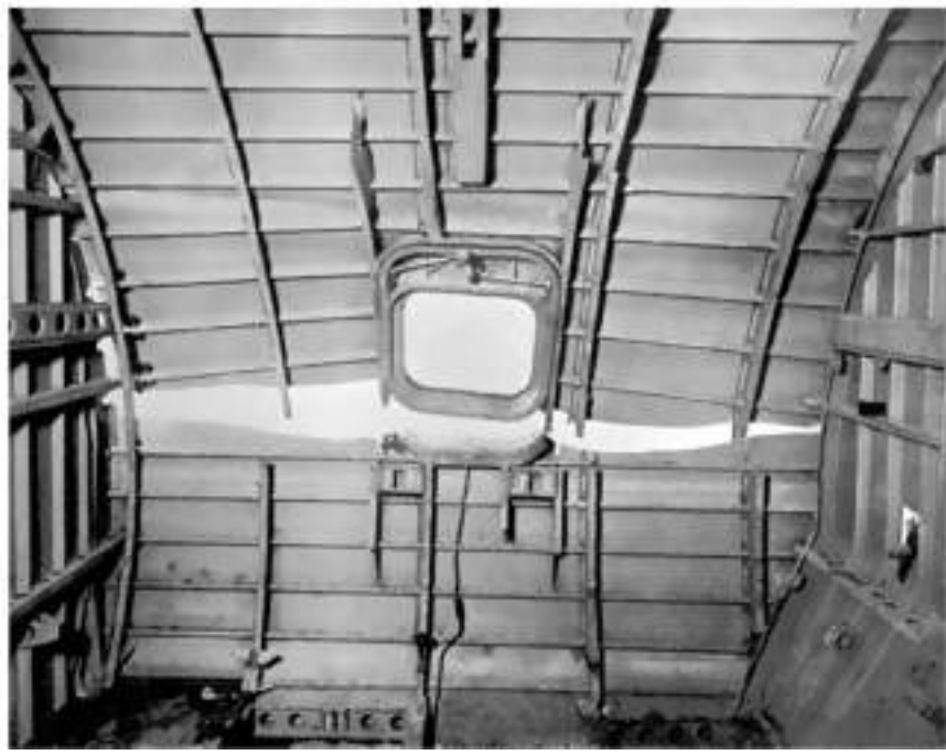
Figura 6.1 – Meccanismo di cedimento per fatica della fusoliera dell'aviogetto de Havilland DH. 106 Comet in corrispondenza di uno dei finestrini - prove di laboratorio sull'esemplare G-ALYU [tratto da Swift 1987 e AA.VV. 1955].
