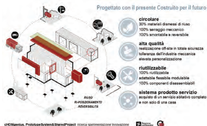
Fig. 1. Schema realizzativo e concettuale del sistema cHOMgenius: componenti assemblati a secco a partire da componenti semplici, interamente realizzato off-site e smontabile.
