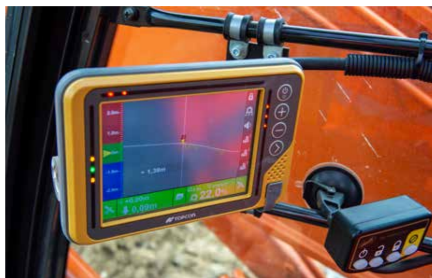
Particolare del sistema di machine control montato su escavatore. Sopra, particolare del sistema di machine control montato su escavatore
