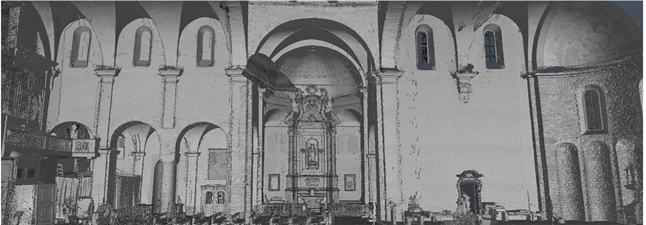
Fig. 2 Nuvola di punti (per velocizzare l'acquisizione dei dati, sono stati usati due laser scanner: Faro Focus HDR130 e Faro Focus s70)
