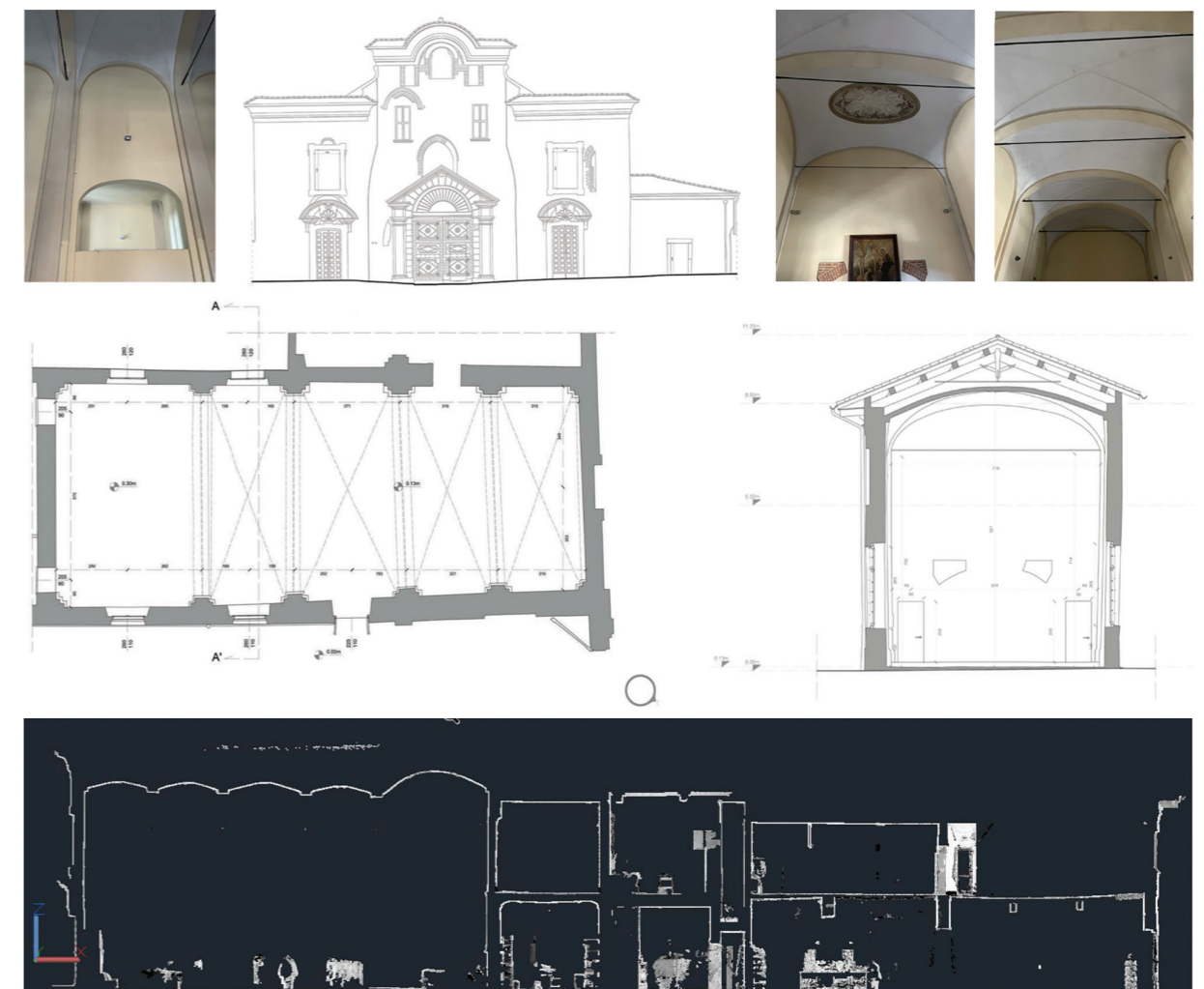
Fig. 6 - Pianta al piano terra della “Chiesa delle donne”, sezione trasversale e longitudinale (nuvola di punti) dell’intero corpo di fabbrica interno della Foresteria; alcune foto dell’interno. In alto, il prospetto su strada dell’ingresso del complesso abbaziale: nel riquadro rosso il corpo di fabbrica della Chiesa delle donne con il suo ingresso.
