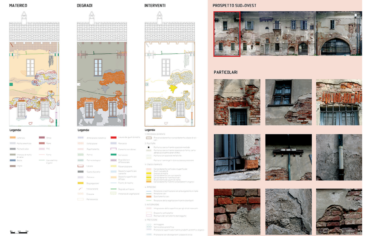
Fig 8 - Da sinistra a destra: il rilevamento dei materiali e del relativo degrado sulla facciata nord-est della Foresteria nonché l'indicazione degli interventi ammissibili per la loro conservazione; alcune foto di dettaglio dello stato attuale dei materiali e del loro degrado (2022).
