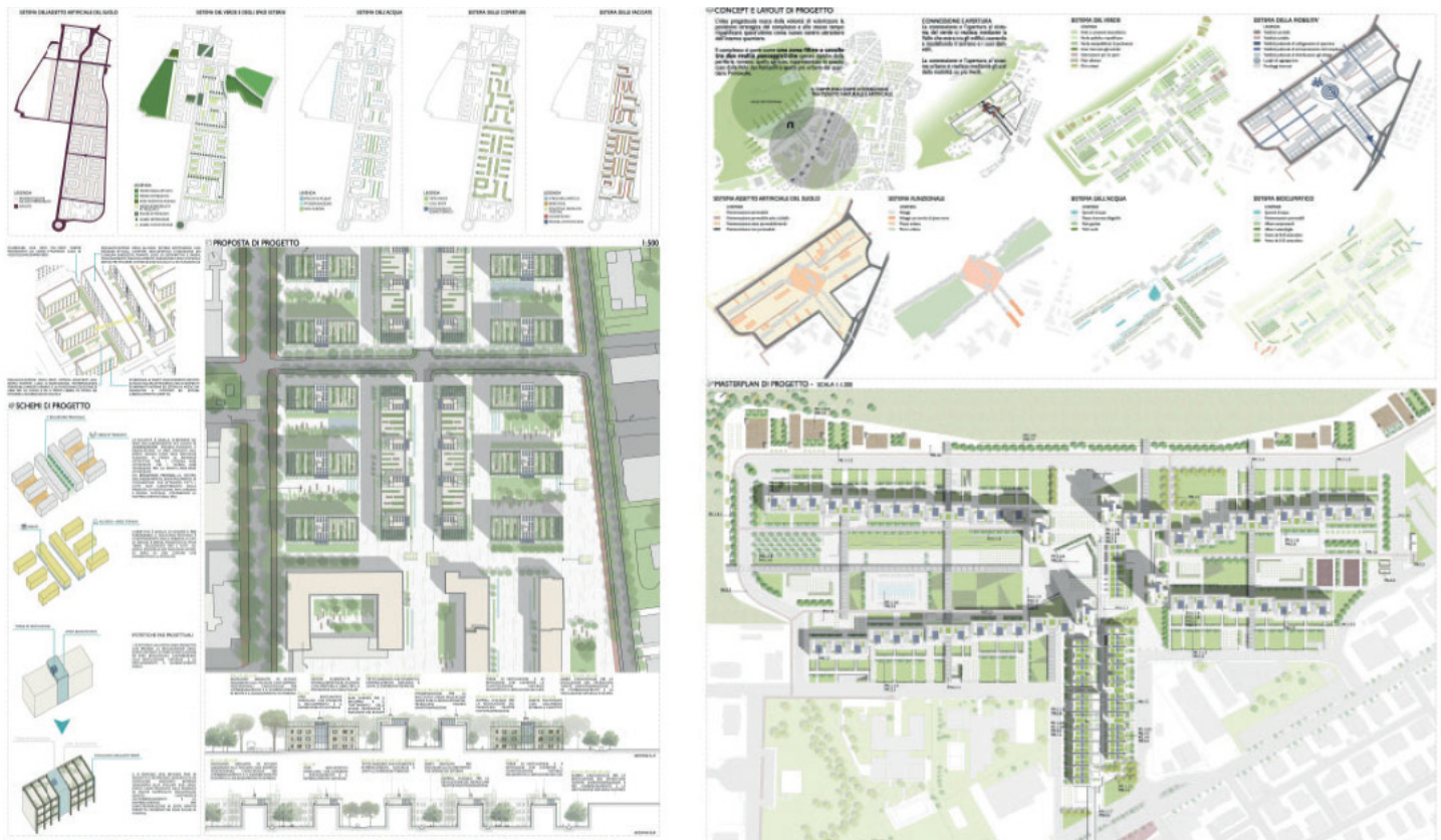
Fig. 4 - Passaggi multiscalari nelle elaborazioni della sperimentazione progettuale-dimostrativa condotta sui quartieri ERP di Primavalle e di Torrecchia, Roma: concept, layout di progetto, planimetria e prospetti a differenti scale / Multiscale steps in the elaboration of the design-demonstration experimentations conducted on the ERP Districts of Primavalle and Torrecchia, Rome: concept, project layout, floor plan and elevations at different scales (Source: Elaboration by Research Unit Sapienza Università di Roma).
