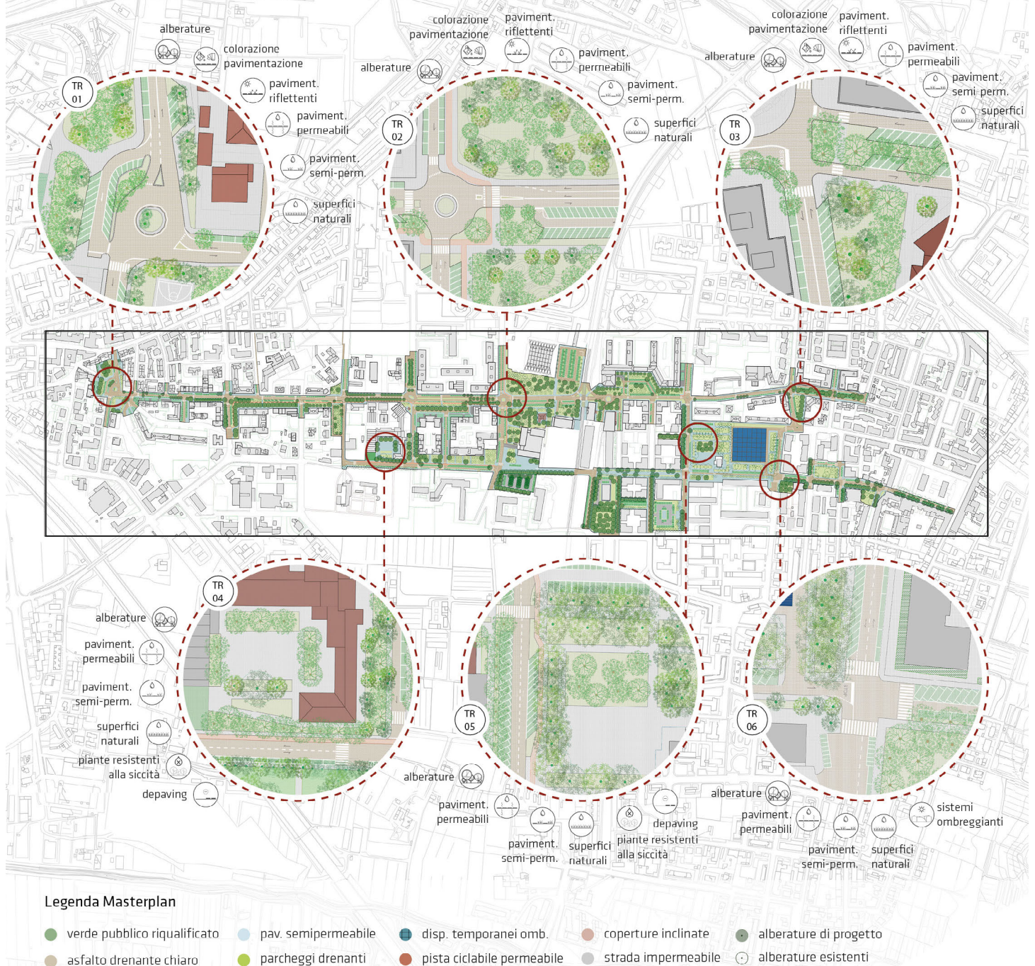
Fig. 24 - Soluzioni tecnologiche e spaziali adottate nella spina del transetto di riqualificazione / Technological and spatial solutions adopted in the intervention area of the renovation transect (Source: Author 'elaboration).
