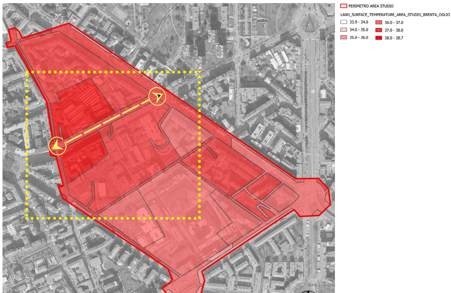
Fig. 38a - Analisi delle caratteristiche termiche dell'ambito di progetto / Analysis of the thermal characteristics of the project area (Source: Elaboration by Davide Cerati).
