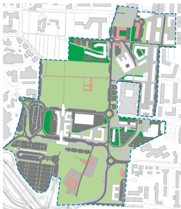
Fig. 19 - Planimetria del transetto delle trasformazioni con riportati gli ambiti spaziali individuati e i rispettivi valori superficiali, percentuali e indice di runoff / Plan of the development transect showing the spaces identified and the respective surface, percentage and runoff values (Source: Authors' elaboration).
