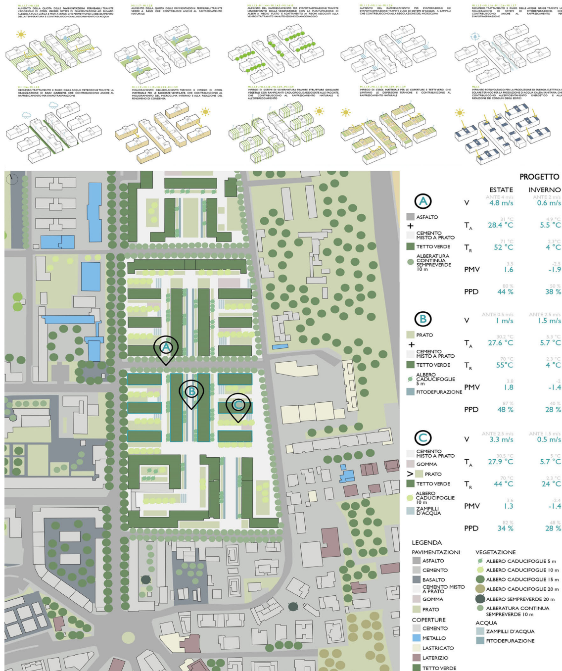
Fig. 40 - Schemi delle principali azioni di intervento e planimetria dell'area intervento con indicazione dei punti chiave di rilevazione dei parametri e relative risultanze delle rispettive simulazioni di comportamento ambientale con confronto ante operam e post operam in 3 punti in relazione alle performance termo e fluidodinamiche / Schemes of the main actions of intervention and planimetry of the intervention area with indication of the key points of detection of the parameters and related results of the respective simulations of environmental behavior with comparison ante operam and post operam in 3 points in relation to the thermal and fluid-dynamic performance (Source: Elaboration by Research Unit Sapienza Università di Roma).
