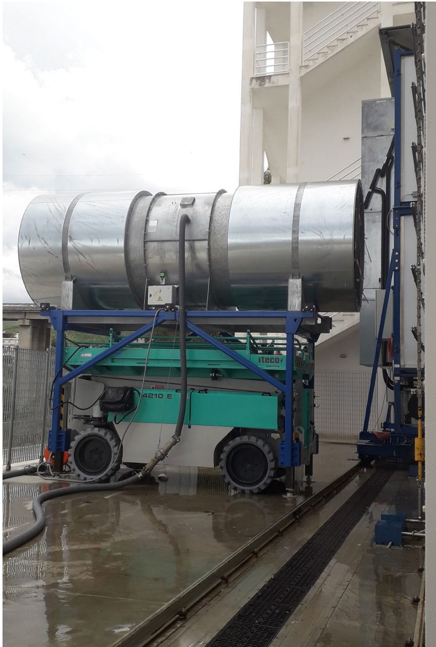
Fig. 32 - Simulazione della bomba d'acqua in presenza di vento / Simulation of water bomb in the presence of wind (Source: Authors' elaboration).
