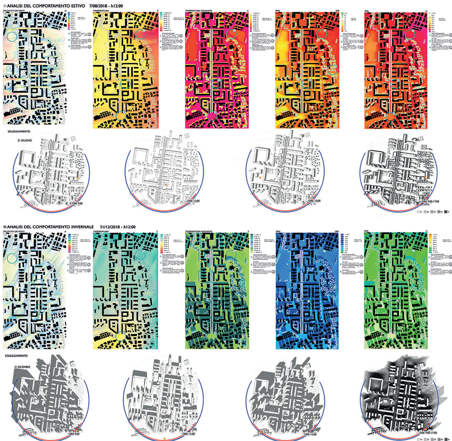
Fig. 25 - Simulazioni dei principali comportamenti bioclimatici estivi e invernali nello stato ante operam del quartiere ex IACP di Primavalle / Simulations of the main summer and winter bioclimatic behaviors in the ante operam state of the ex IACP district of Primavalle (Source: Elaboration by Research Unit Sapienza Università di Roma).
