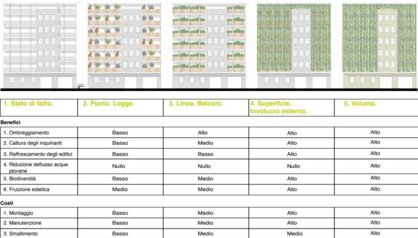
Fig. 31 - Edifici moderni. Studio delle alternative metaprogettuali e dei possibili costi di realizzazione / Modern buildings. Study of meta-project alternatives and possible implementation costs (Source: Elaboration by Federica Donadoni).
