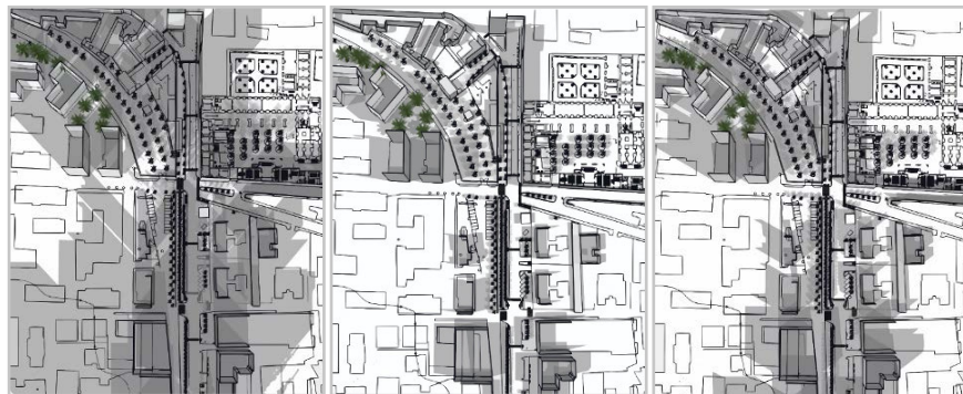
Fig. 37 - Mappe di protezione solare dell'area campione Aversa Annunziata: a) solstizio d'inverno, b) solstizio d'estate, c) equinozio / Sun protection maps of pilot area Aversa Annunziata: a) winter solstice, b) summer solstice, c) equinox (Source: Authors' elaboration).
