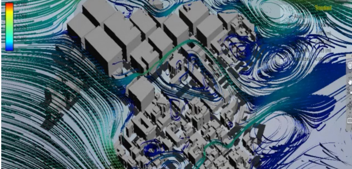
Fig. 17 - Simulazione Modellata dell'andamento dei venti prevalenti sul Distretto GOM/Parco Caserta. / Modeled simulation of winds in the GOM/ Park Caserta District. (Source: Authors' elaboration).
