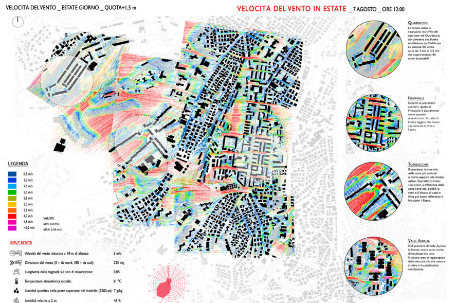
Fig. 16 - Velocità del vento (Wind Speed) in estate dell'area oggetto di sperimentazione / Wind Speed in Summer of the area under experimentation (Source: Elaboration by Research Unit Sapienza Università di Roma).
