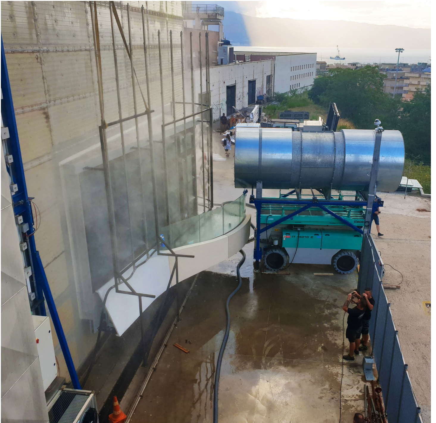
Fig. 1 - Test all'uragano di una facciata curva aggettante. Standard AAMA 501.1-5 / Hurricane test of a projecting curved facade. Standard AAMA 501.1-5. (Source: Authors' elaboration).
