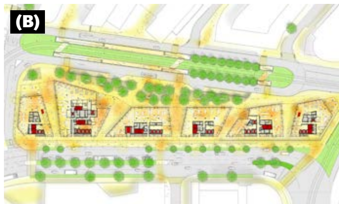
Disegni di localizzazione (sezione orizzontale). Sviluppo planimetrico dei corpi di fabbrica all'interno del lotto (A) e determinazione spaziale interna secondo l'applicazione dei blocchi contenenti i servizi, le strutture di elevazione puntiformi e la distribuzione delle funzioni (B)
