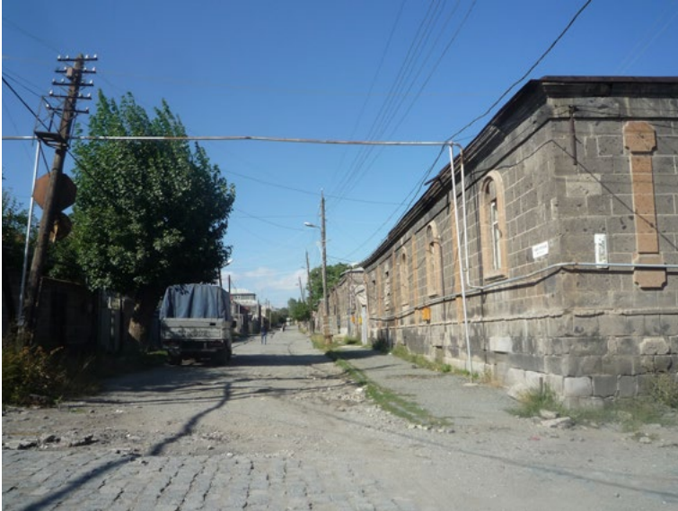
Figura 5. Gyumri (Armenia). Veduta di una strada della parte est del nucleo storico. Gli edifici a un piano sono in blocchi di tufo nero con i semplici elementi decorativi dello stesso materiale nella variante rossa (foto R. Simonelli, 2012).
