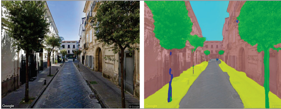
Figura 1. Confronto tra l'immagine originale ottenuta da Google Street View e la sua elaborazione tramite segmentazione semantica. La classificazione automatica evidenzia tutte le classi semanticamente rilevate dal modello DeepLab v3+.
