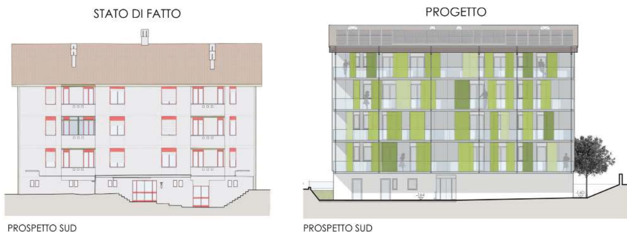
Figura 2. Caso studio di Cinisello Balsamo – confronto fra lo stato di fatto (a sinistra) e il progetto (a destra).
