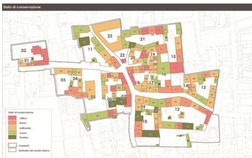
Fig. 15 – Lo stato di conservazione delle unità edilizie: quadro di sintesi della valutazione qualitativa condotta attraverso il censimento delle unità edilizie del nucleo storico
