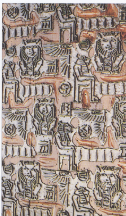
Sopra: un'operatrice disegna la "messincarta" del tessuto. Sotto: blocco da stampa in legno con motivi realizzati in lamina di piombo.
