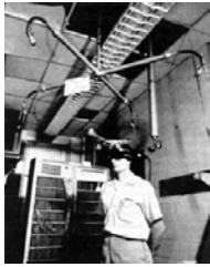
[ 5 . 1 3 ] HMD (Sword of Damocles), svilup- pato nel 1966 (Fonte: Vedi nota n.10)
