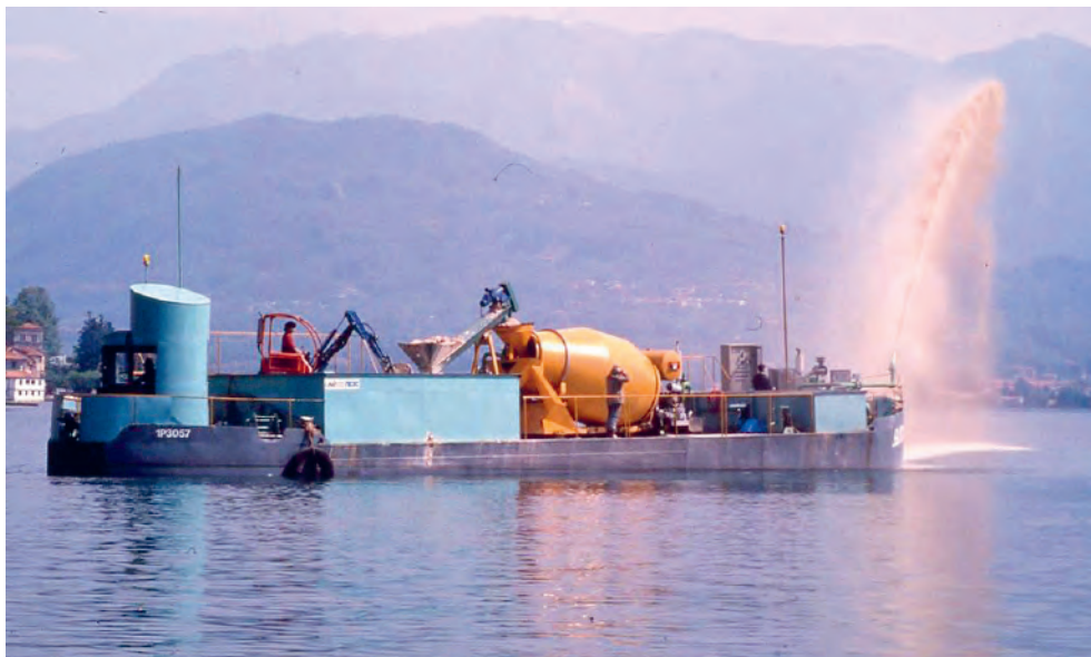
Figura 4. Il battello Sant'Angelo allestito per versare il carbonato di calcio nel lago.
